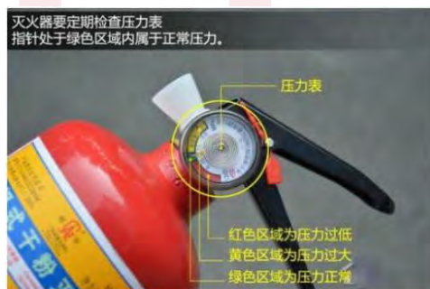
图 7.4: 灭火器压力表
