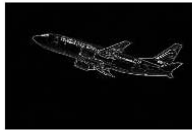
图 9.10 利用梯度进行彩色图像的边缘检测
