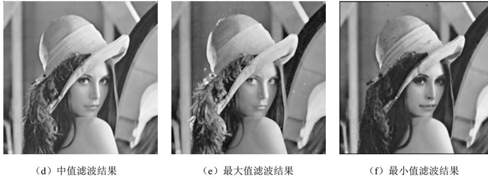
图 6.2 灰度图像的顺序统计滤波
