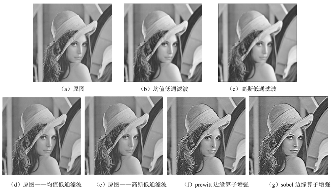
图 5.6 灰色图像平滑、锐化
