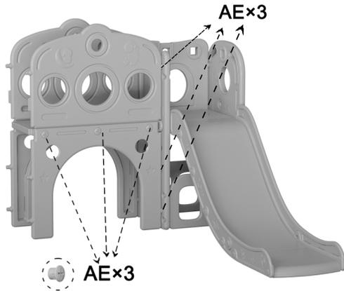
正面パネルCの合わせボタンをU型パネルBの穴に合わせて、十字ナットAEで締め付けます。そして、十字ナットAEを締めて、土台Kを正面パネルCに固定します。
