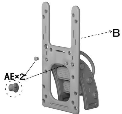
取り付けした階段をU型パネルBの穴に合わせて、十字ナットAEで締め付けます。
