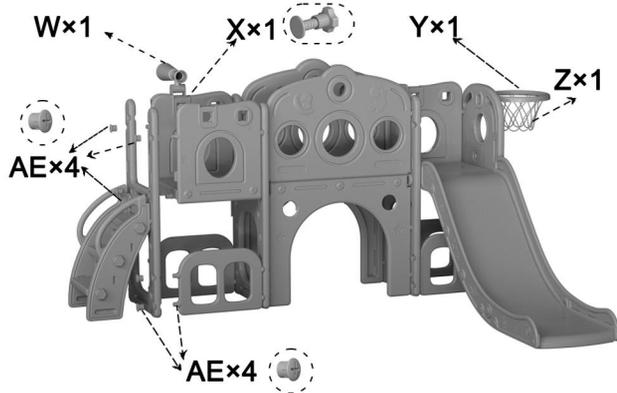
取り付けした階段を正面パネルC、正面パネルDと土台Kに合わせて、十字ナットAEで締め付けます。
