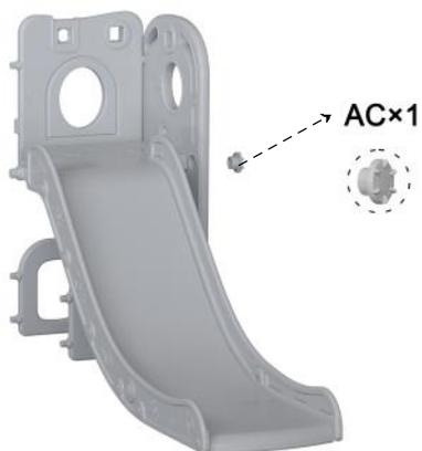
滑り台（上部）のボタンを側面パネルAの穴に合わせて、ナットACで締め付けます。
