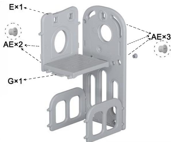
土台 G の合わせボタンを上面パネル E の穴に合わせて、十字ナット AE で締め付けます。
