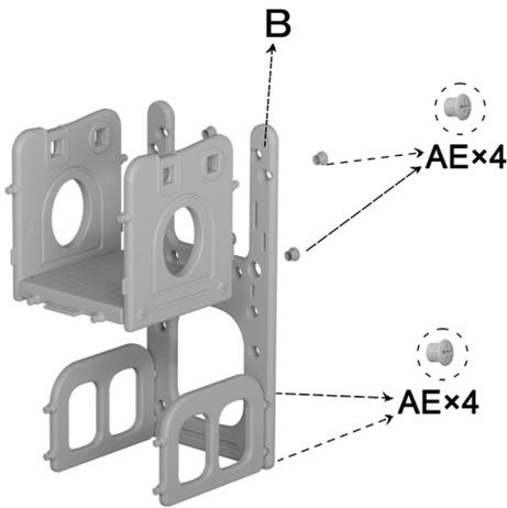
取り付けした土台Lと下部パネルの合わせボタンをU型パネルBの穴に合わせて、十字ナットAEで締め付けます。
