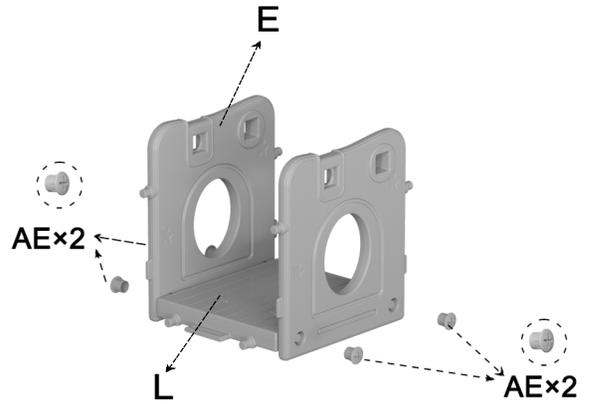
上面パネルEの合わせボタンを土台Lの穴に合わせて、十字ナットAEで締め付けます。
