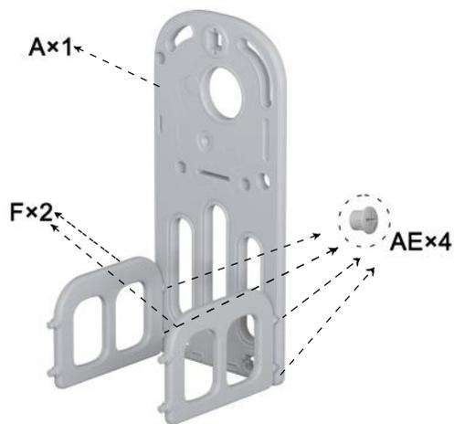
底部パネル F の合わせボタンを側面パネル A の穴に合わせて、十字ネット AE で締め付けます。
