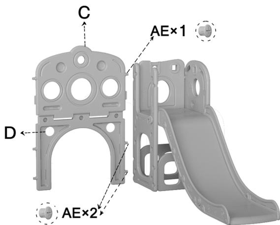
正面パネルCと正面パネルDの合わせボタンをU型パネルBの穴に合わせて、十字ナットAEで締め付けます。
