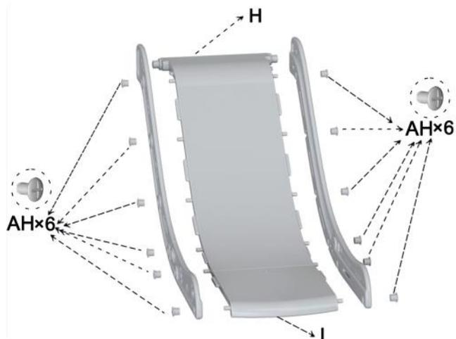
滑り台(下部)I を滑り台(上部)H に載せ、滑り台(上部)H と滑り台(下部)I の合わせボタンを手すり J の穴に合わせて、ナット AH で締め付けます。
