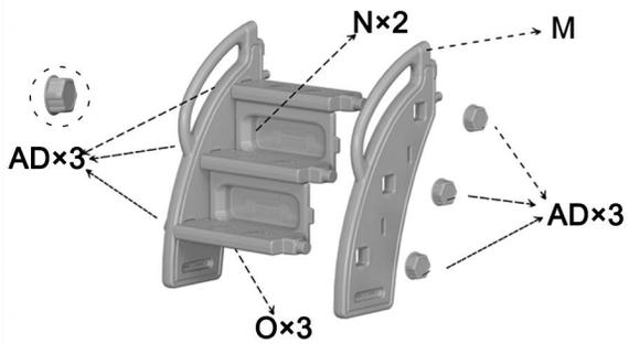
ステップOとスタンドNの合わせボタンを手すりMの穴に合わせて、ナットADで取り付けます。
