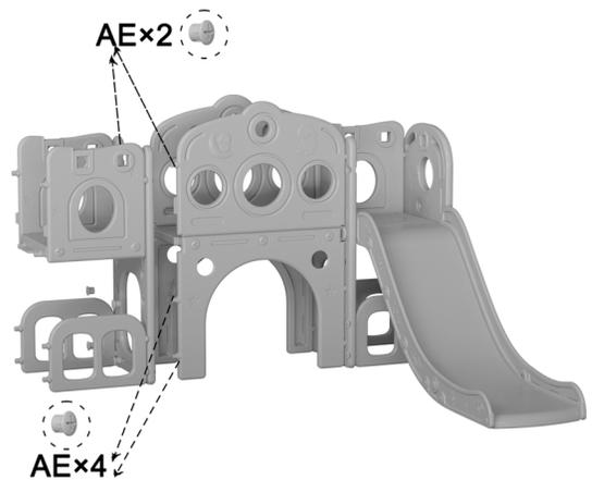
正面パネルC、正面パネルDと土台Kの合わせボタンをU型パネルBの穴に合わせて、十字ナットAEで締め付けます。
