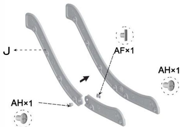
ナット AF とナット AH を締めて、手すり J の上部と下部を連結します。
