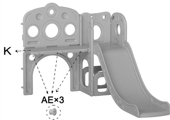
土台Kの合わせボタンを正面パネルCの穴に合わせて、十字ナットAEで締め付けます
