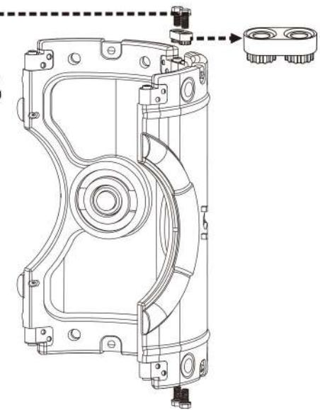
STEP5: STEP 1で完成した部品に STEP 4で完成した滑り台を乗せ、外側からナット(E.G)を通し、内側からネジ(D)で固定し、簡易スパナで締付けます。
