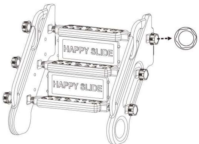
STEP14:STEP13 で完成した部品に STEP11 で完成した部品を乗せ、穴の位置を合わせます。
