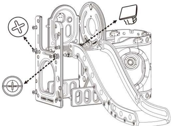
STEP10:STEP 8で完成した部品に STEP 9で完成した部品を乗せ、外側からナット(G)を通し、簡易スパナで締付けます。
