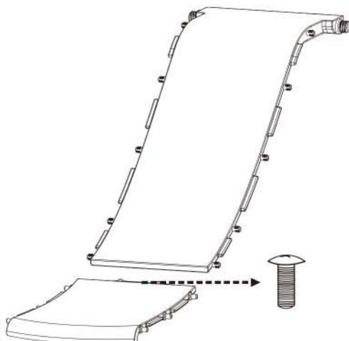
STEP1: パネル(⑯)に⑰を二つ乗せ、外側からナット(G)を通して、簡易スパナで締付けます。
