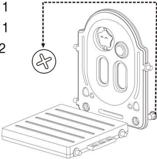
STEP8:STEP 7で完成した部品に STEP 5で完成した部品を乗せ、穴の位置を合わせます。
