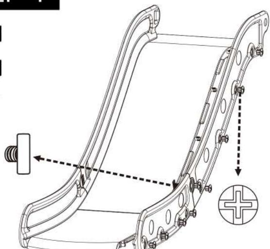
STEP3: 上部の手すり(④)と下部の手すり(③)をすべり台ボードにはめ、取付穴を合わせます。ナット(F)を取り付け、簡易スパナで締付けます。上部の手すりと下部の手すりの中央部は、ナット(I,F)で固定します。
