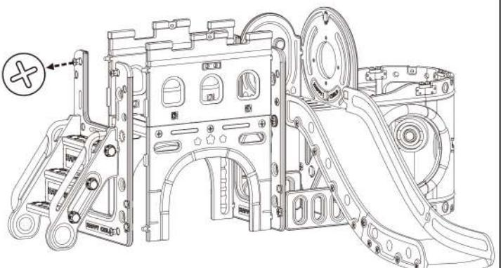
STEP16: パネル(⑯)に STEP15で完成した部品を乗せ、ナット(G)を通し、締付けます。
