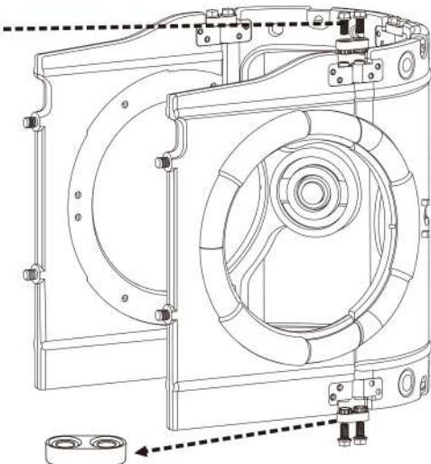
STEP7: パネル(㉐)をパネル(㉒)に乗せ、上下から留め具(B)とネジ(A)で締付けます。向こう側も同じように組み立てます。
