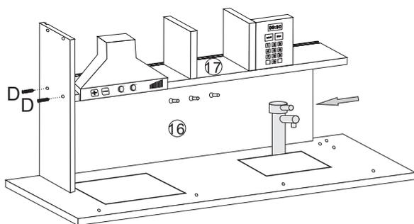
フックを取り付けた背板⑯を台板⑫の溝に差し込んだ後、
