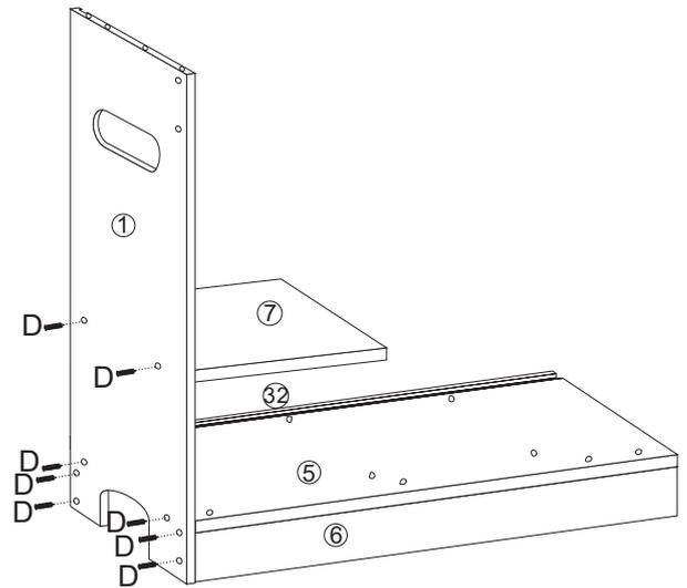
側板①をネジDで底板⑤に取り付けます。
