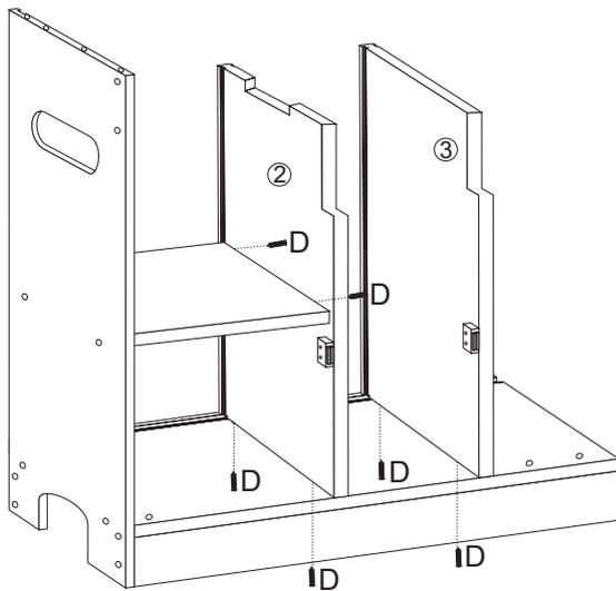
図の順序に従って、中間の仕切り板②と③をネジDで底板⑤に取り付け、棚板⑦の反対側を仕切り板②に固定します。
