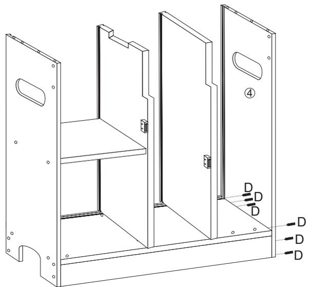
側板④をネジDで底板に固定します。
