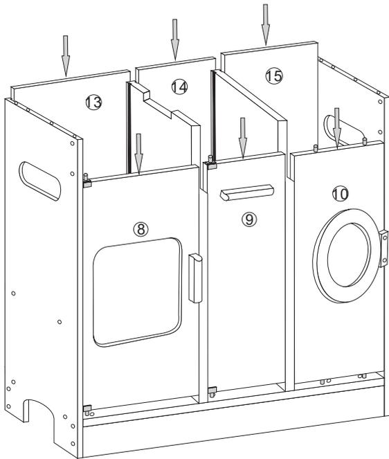
図の位置に従って、背板⑬,⑭,⑮を仕切り板の溝に合わせて上から差し込むようにはめてください。
