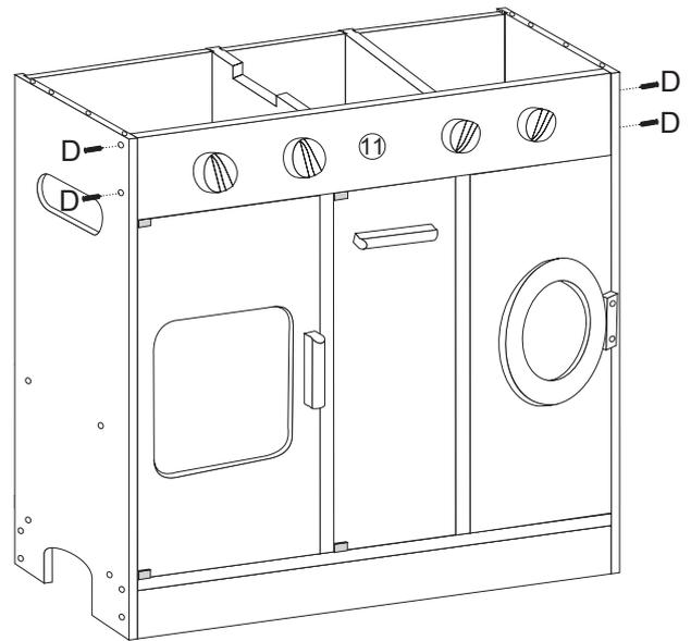
つまみ付きの板⑩の下の溝を3つのドアの上部のダボに合わせ、ネジDで両側の側板に固定します。
