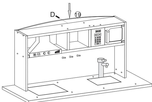
背板⑱を両側の側板の溝に沿って棚板⑰の溝に差し込み、
