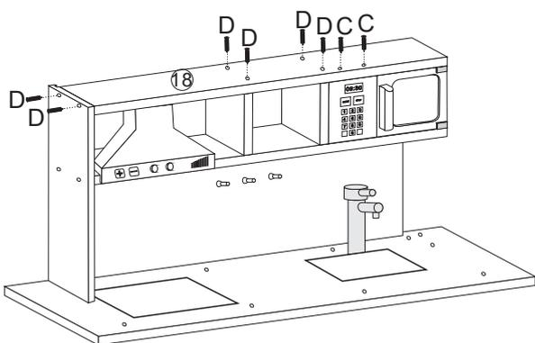
天板⑱をネジDで側板⑳、仕切り板㉒と㉓を固定します。
