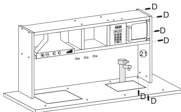
側板㉑をネジDで取り付けます。
