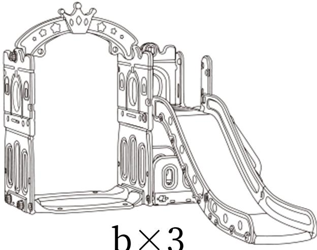
5.1 図のように、(F)と(G)に(D)を乗せ、穴の位置を合わせ、外側からナット(b)で締付けます。
