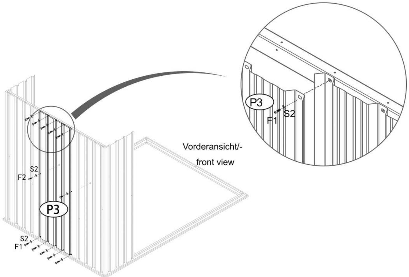
図のように、完成した部品に(P3)を乗せ、穴を合わせます。
