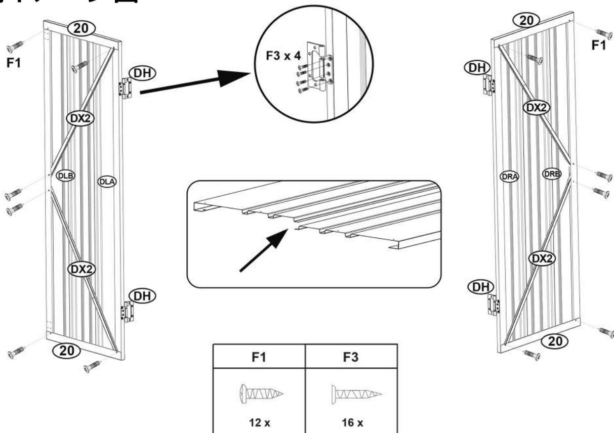
図のように、(DLB)に(DLA)を乗せ、その後、(20)、(DX2)、(DH)を配置し、穴を合わせます。ネジF1、F3を通し、ドライバーで締付けます。
