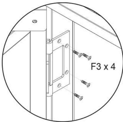
図のように、ドアを本体に乗せます、ボルトF3を通し、ドライバーで締付けます。
