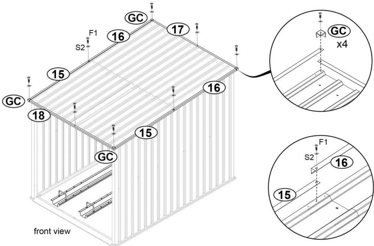
図のように、STEP 13で完成した部品に(15)(16)(17)(18)を乗せ、その後、上に(GC)を配置し、穴を合わせます。
