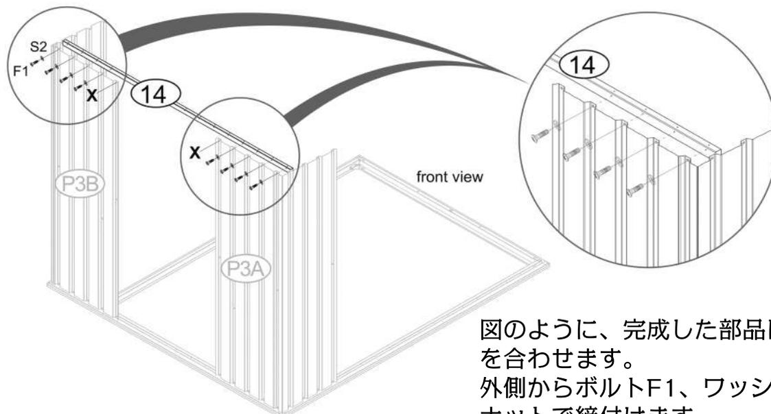
図のように、完成した部品に(14)を乗せ、穴を合わせます。
