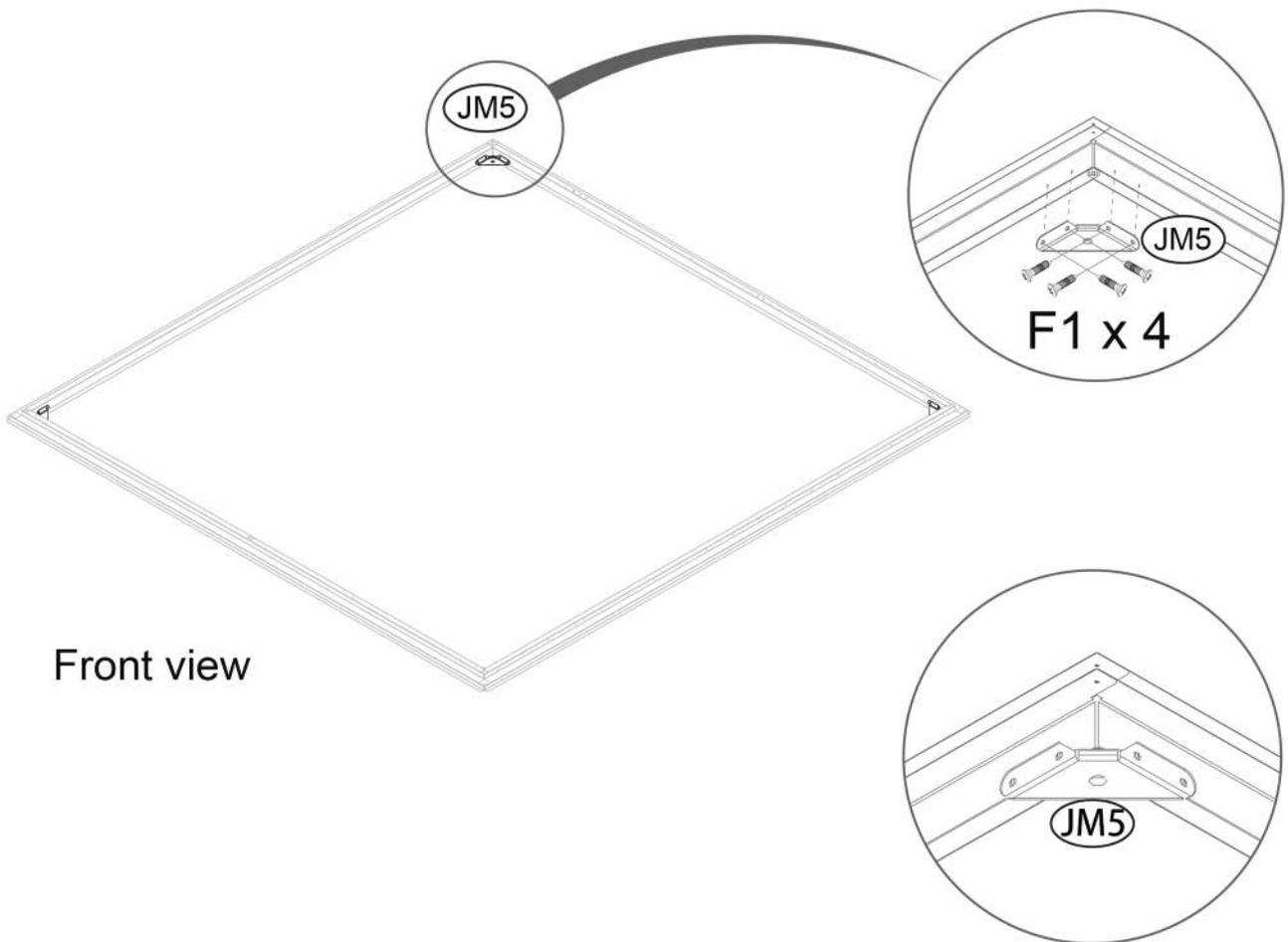
図のように、STEP1で完成したベースに(JM5)を乗せ、穴を合わせます。
