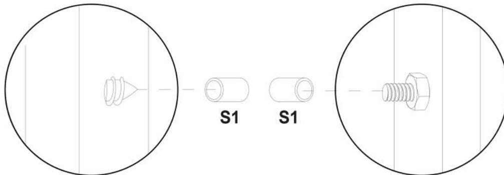
取り付けられているすべてのネジF1とボルトF2をS1でカバーします。
