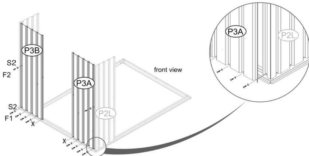
図のように、STEP3で完成した部品に(P3A)と(P3B)を乗せ、穴を合わせます。
