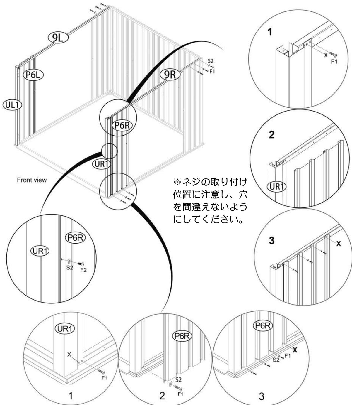
図のように、完成した部品に(P6R)と(9R)を乗せ、穴を合わせます。
