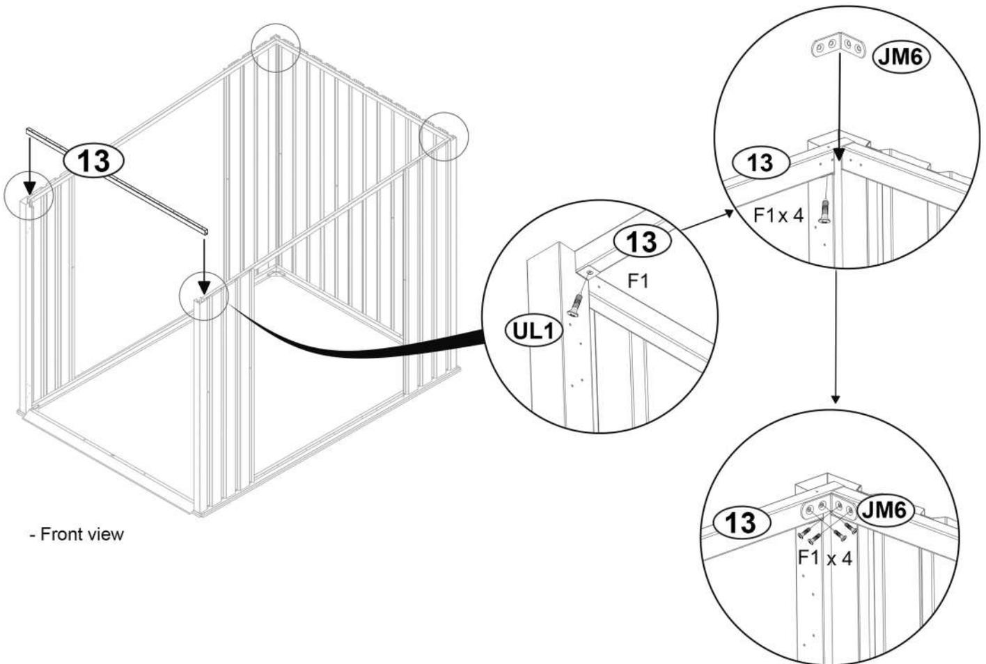
図のように、完成した部品に(13)と(JM6)を乗せ、穴を合わせます。
