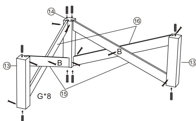
ネジBを締めて、部品15と部品16をクロスさせて取り付けてください。
