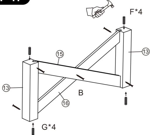
ネジBを締めて、部品15と部品16をクロスさせて取り付けてください。
