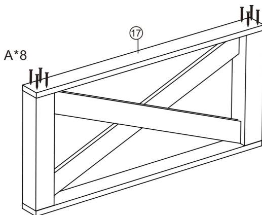
ネジA×8を締めて、部品17を部品13に取り付けてください。
