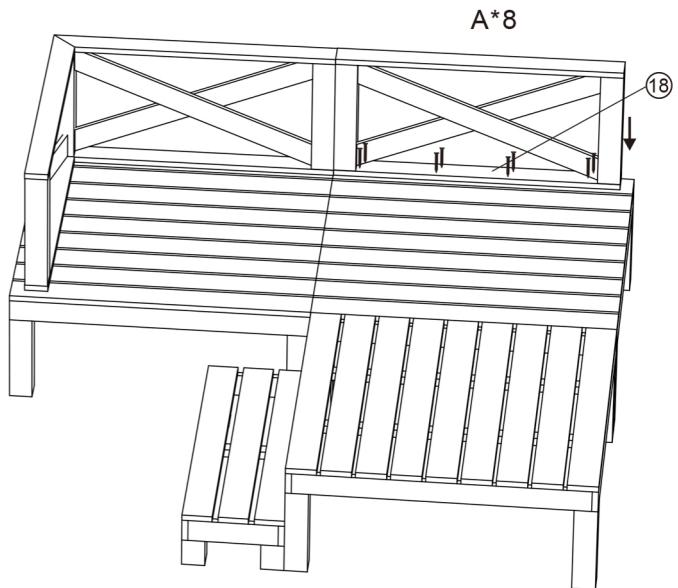
ネジA×8を締めて、部品18を部品10に取り付けてください。
