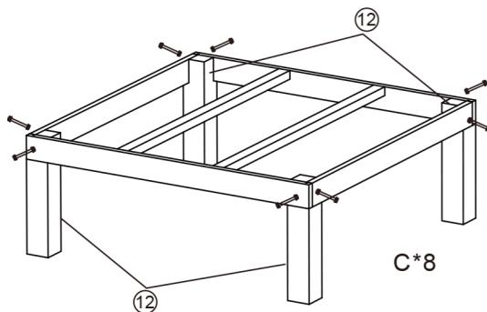
ネジC×8を締めて、部品12を固定されてください。
