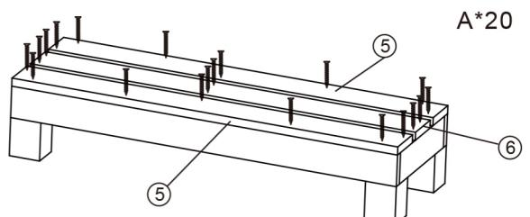
ネジA×14を締めて、部品5を部品1、部品2と部品3に取り付けてください。
