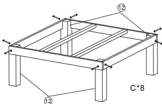
ネジC×8を締めて、部品12を固定してください。
