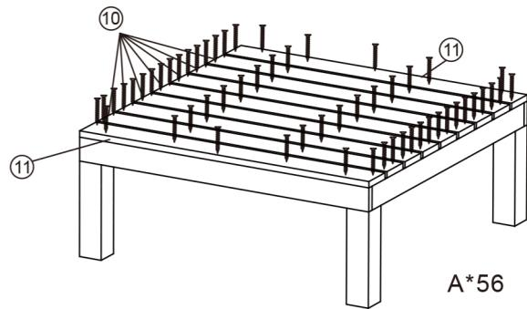
ネジA×14を締めて、部品11を部品7、部品8と部品9に取り付けてください。
