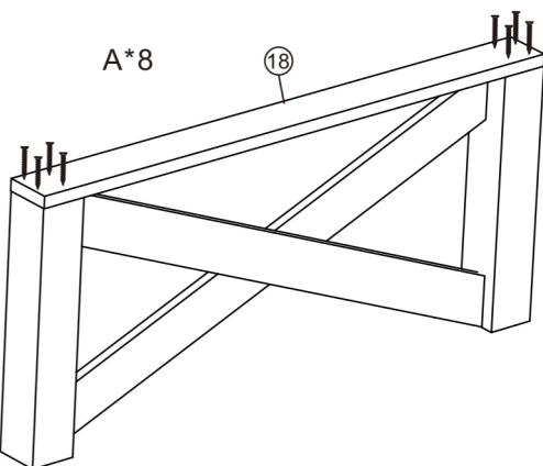
ネジA×8を締めて、部品18を部品13に取り付けてください。
