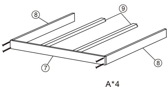
ネジA×4を締めて、部品7を部品8に取り付けてください。
