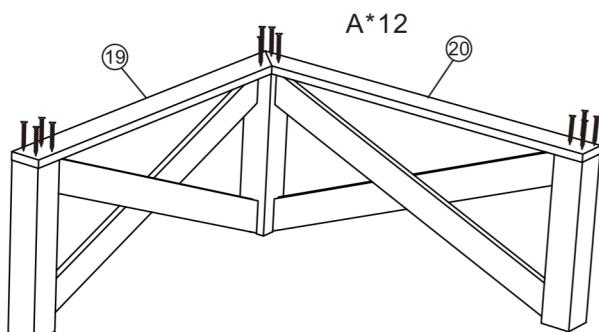
ネジA×6を締めて、部品19を部品13と部品14に取り付けてください。
