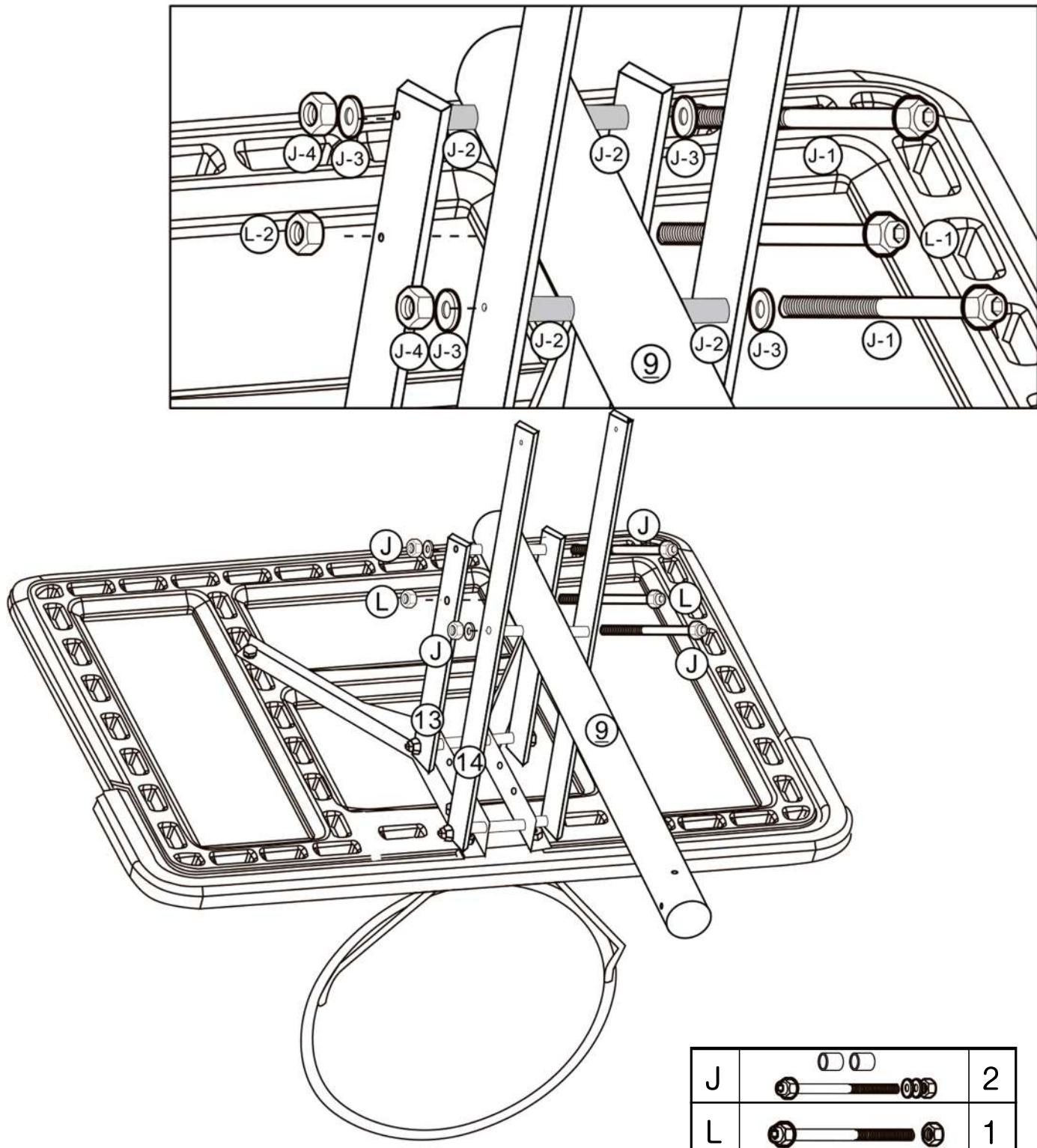
接続パイプ（⑬、⑭）をトップチューブ（⑨）に取り付け、ネジ（J）で締めます。
