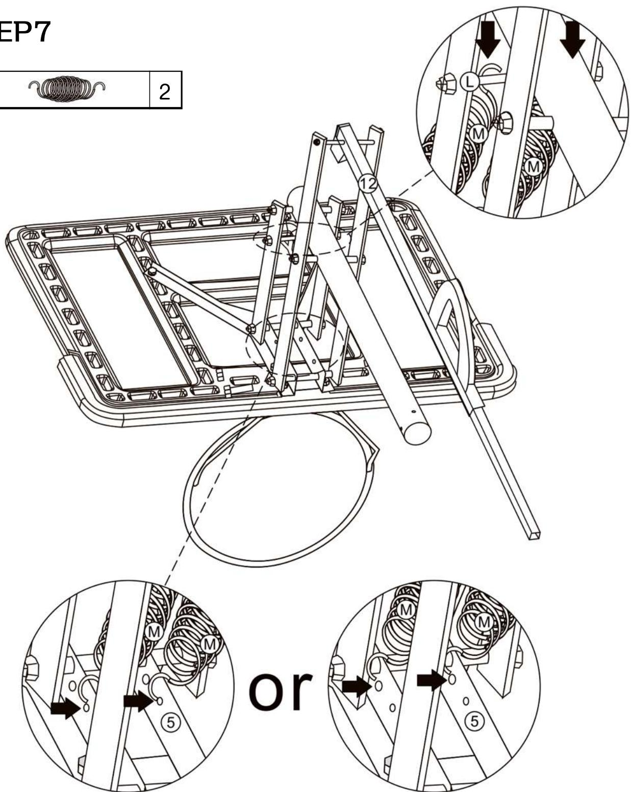
スプリング (M) を部品 (5) に掛け、バネフック (O) を使用してスプリングの反対側をネジ (L) に掛けます。
