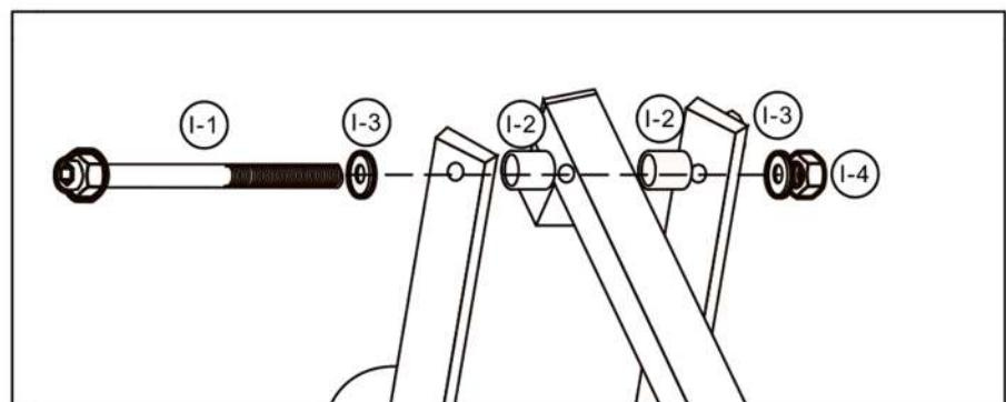
2. ネジ (I) を接続パイプ(長) (14) 、コネクタ (15) と調整レバー (12) に通します。締めてロックします。
