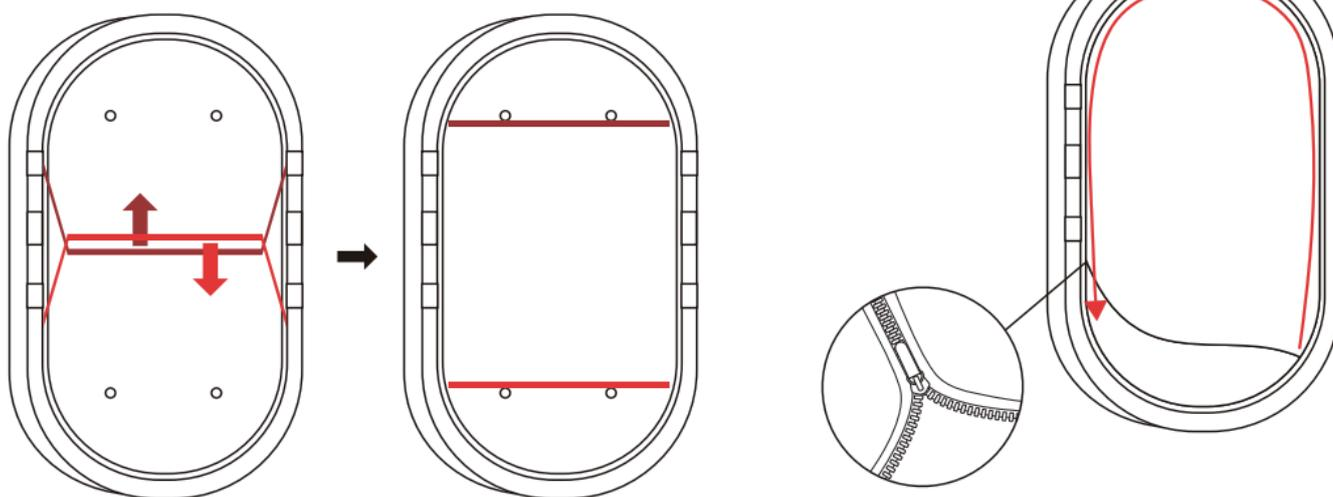
**1** 図のように金属製フレームをバスケットの両端に押しつけ、金属製フレームを直立状態にします。
