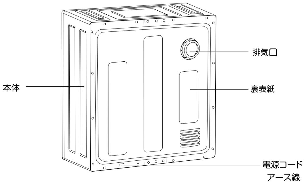
温風排気口出口と電源コード口は壁から10 cm以上離して設置してください。
