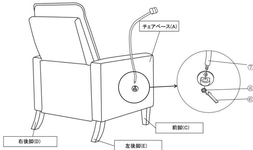
チェアベース(A)の左側に、ナット(⑧)とスパナ(⑥)を使って、携帯電話ホルダー(⑦)を時計方向に回し取り付けます。
