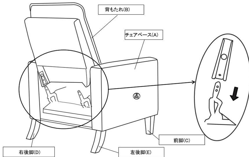
背もたれ(B)の側面にあらかじめ取り付けられているブラケットを、上図のようにチェアベース(A)にあらかじめ取り付けられているスライドロック金具に差し込みます。
