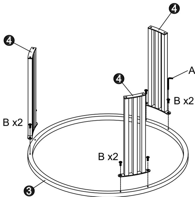
**ご注意：**取り付けをスムーズに進めるために、ステップ1とステップ2の取り付け時には、ネジを80%回転させてください。その後、部品3、部品4、部品5が組み合わさった後に各ネジを締め付けてください。
