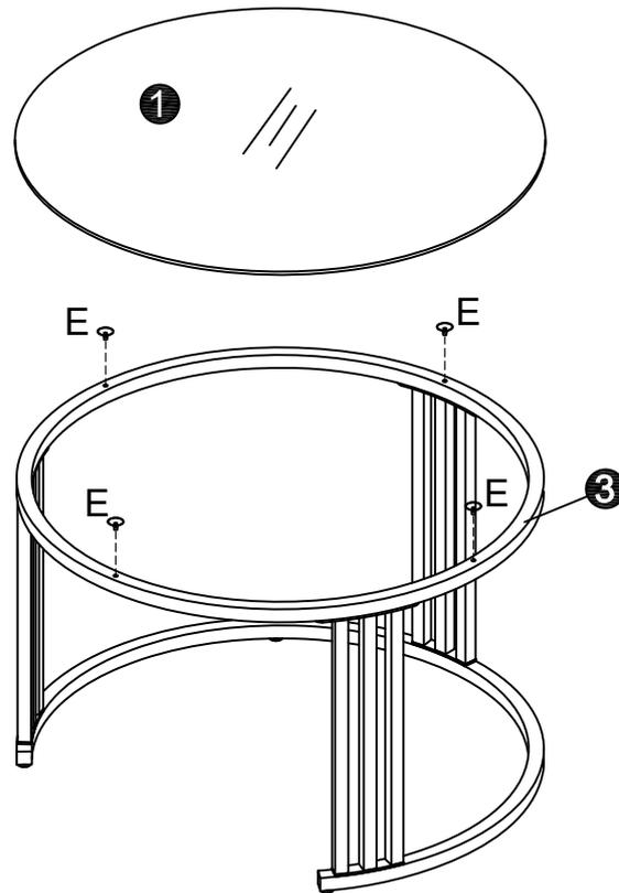
図のように、部品E×4を対応する穴、次に部品1のガラス天板を部品3に合わせて配置し、下に押し下げてしっかりとリンクさせてください。
