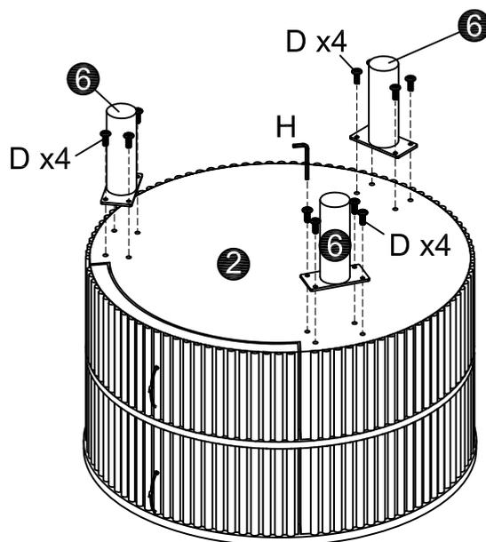
図のように、部品HとネジD×12を使用してまず部品6、部品2を組み合わせ、ネジD×12を締めて取り付けてください。
