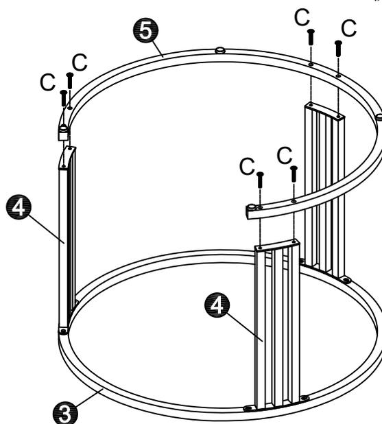
**ご注意：**取り付けをスムーズに進めるために、ステップ1とステップ2の取り付け時には、ネジを80%回転させてください。その後、部品3、部品4、部品5が組み合わさった後に各ネジを締め付けてください。
