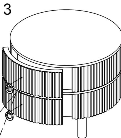
図のように、ネジG×2を使用してまず部品F、部品3を組み合わせ、ネジG×2を締めて取り付けてください。
