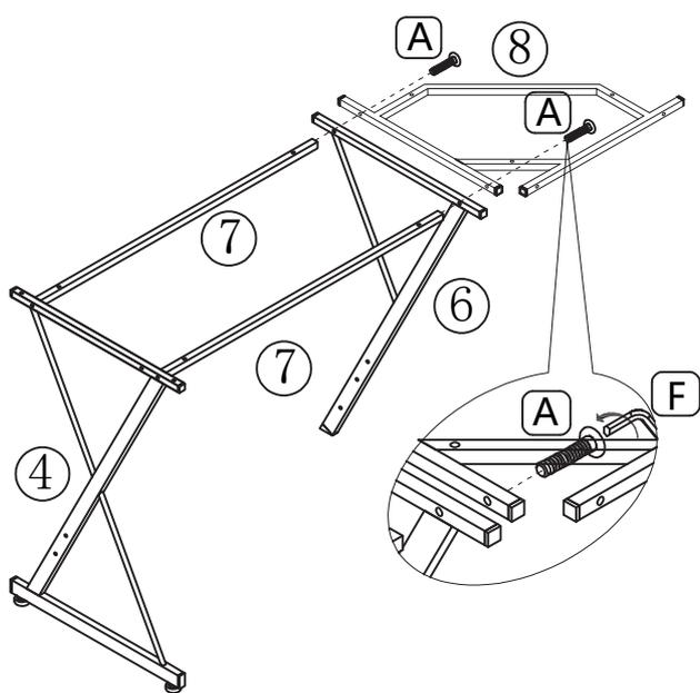
3. ネジAを使用。完成したフレームに部品⑥と⑧をAで取り付けます。
