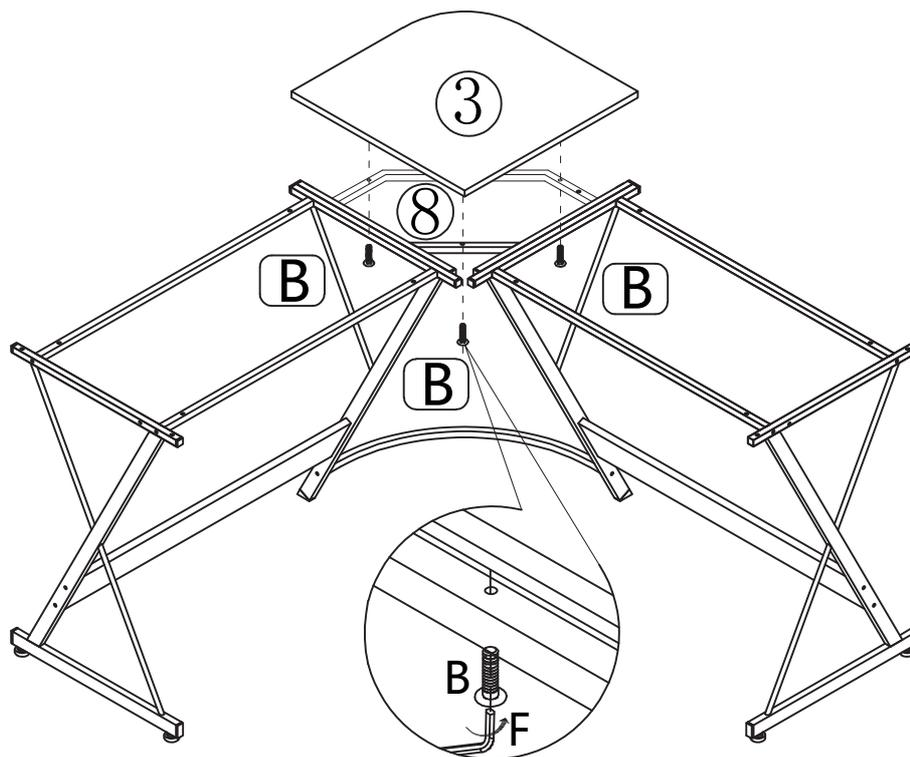
7. ネジBを使用。フレームに③天板を取り付けます。
