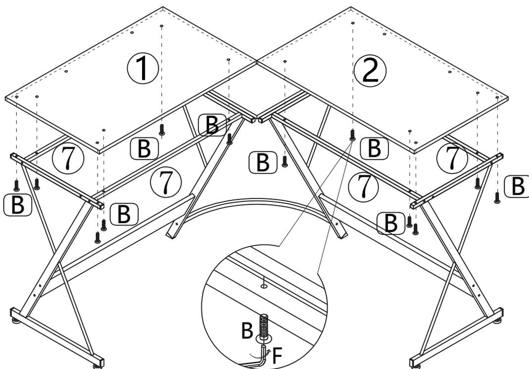
8. ネジBを使用。フレームに天板①と②を取り付けます。
