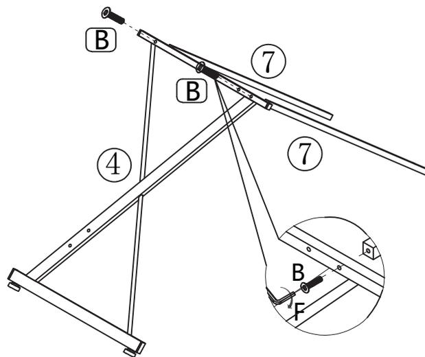
2. ネジBを使用。フレーム④、⑦をBで取り付けます。
