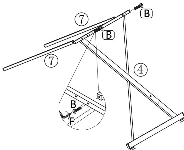
4. ネジBを使用。フレーム④、⑦をBで取り付けます。
