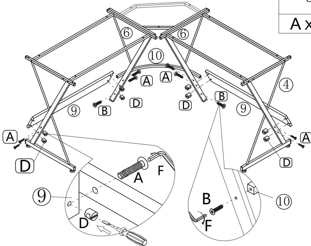
6. ネジA、B、Dを使用。⑨板と⑩パイプをフレームにネジA、B、Dで取り付けます。
