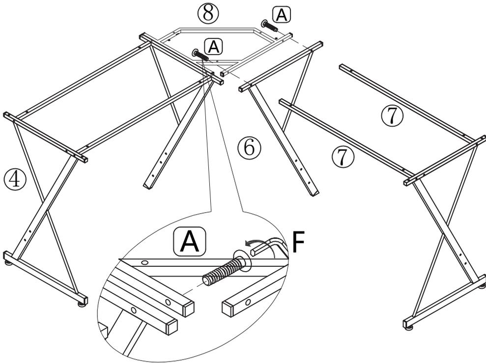
5. ネジAを使用。S3とS4完成したフレームと部品⑥をネジAで取り付けます。
