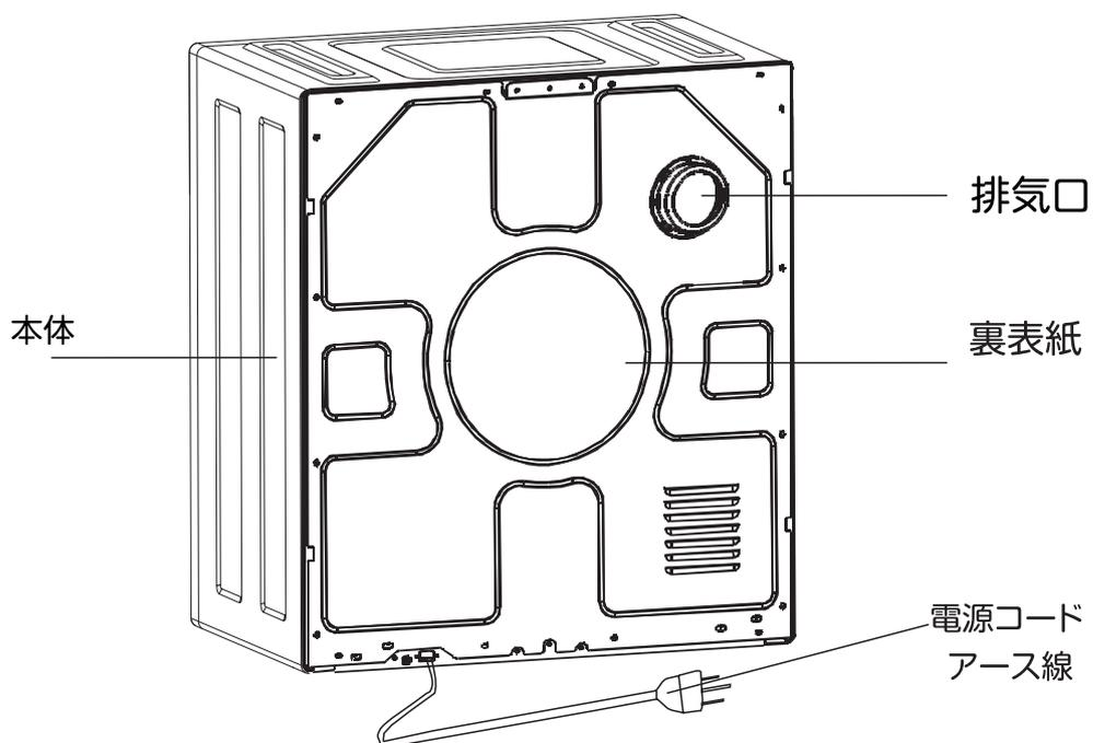
温風排気口出口と電源コード口は壁から15cm以上離して設置してください。
