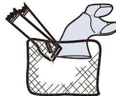
コートやジャンパーなど大型商品を乾燥する場合、衣類は裏返しにして乾燥します。運転タイマーを120分以上で設定し、乾燥に応じて追加で再設定してください。
