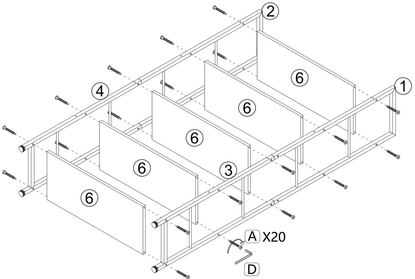
ステップ3: 部品⑥をネジAで部品①、②、③、④に固定します。
