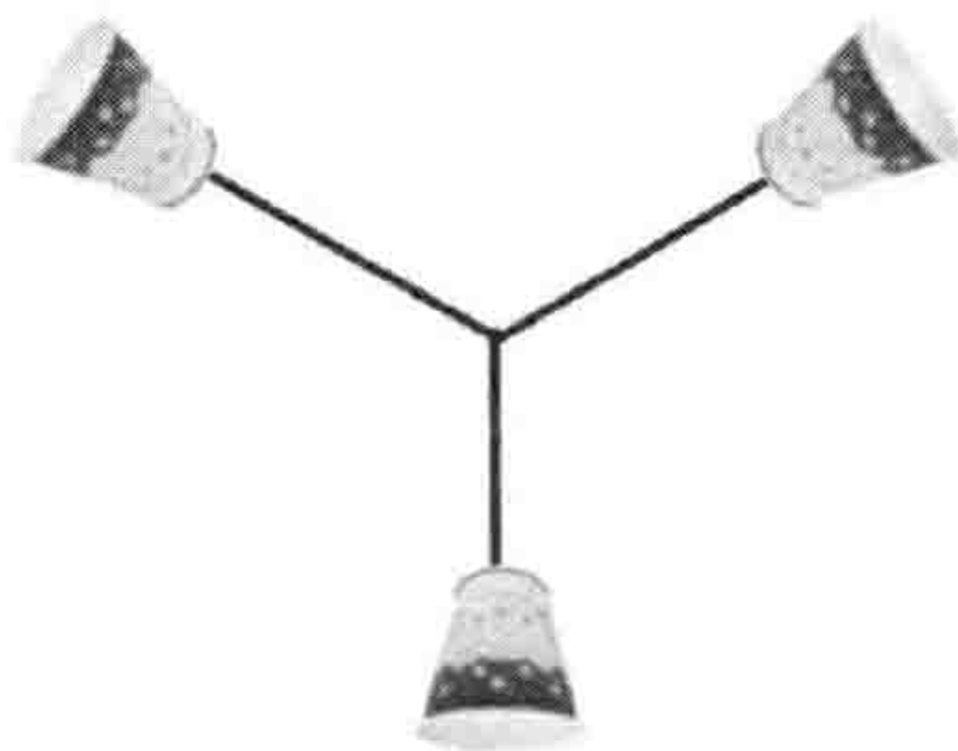
图12-2 纸杯电话系统中引入复用技术
