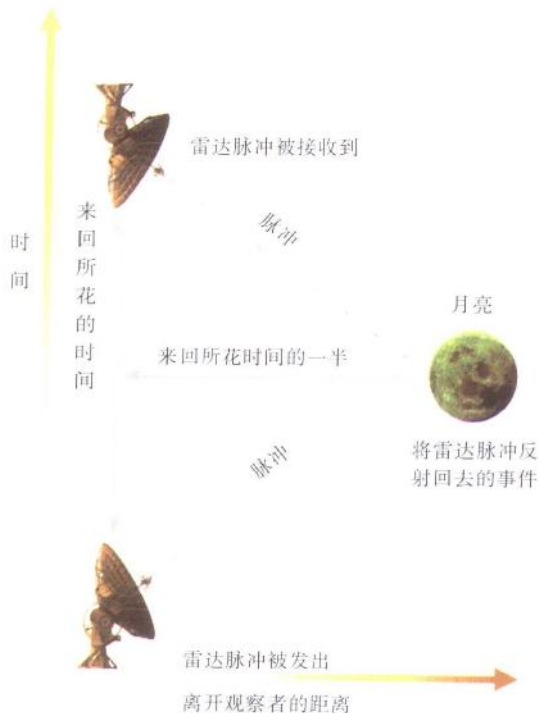
图 2.8 时间用垂直坐标测量，离开观察者的距离用水平坐标测量。观察者在空间和时间里的途径用左边的垂线表示。到事件去和从事件来的光线的路径用对角线表示。
